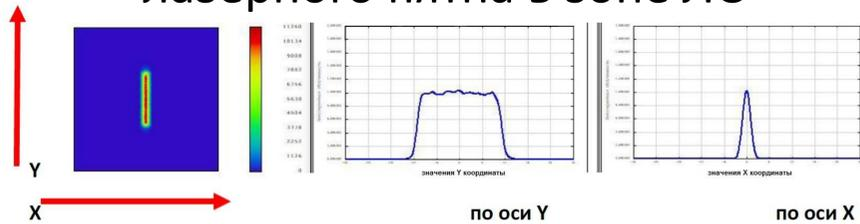
Распределение (а) и профили интенсивности ЛИ по осям Y (б) и X (в) в пятне на поверхности образца (получено расчетным методом по данным ООО «НПП «Инжент»)
